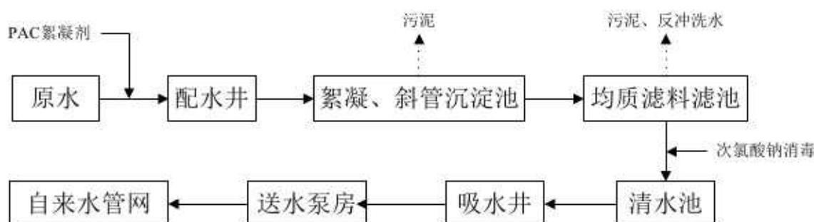
图 9 项目水处理工艺流程图
