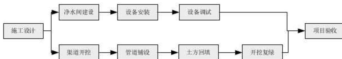
图 8 项目施工工艺流程图
