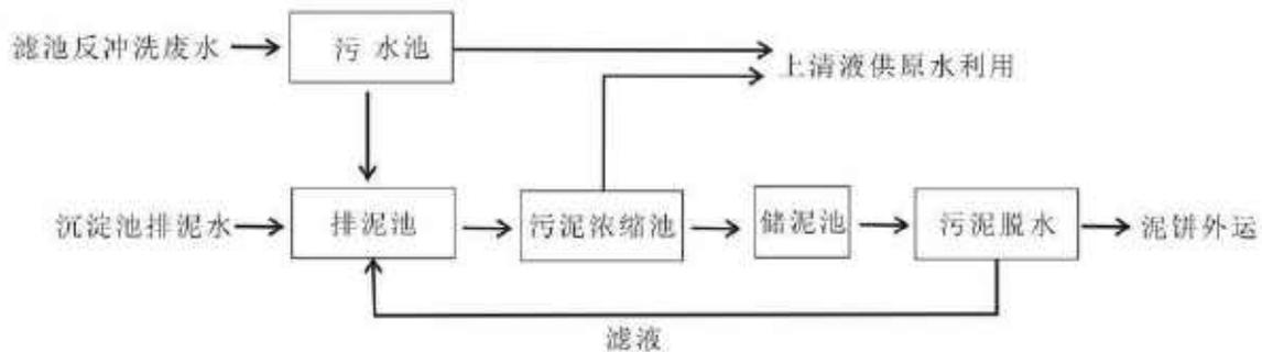
图 10 生产废水处理工艺流程
