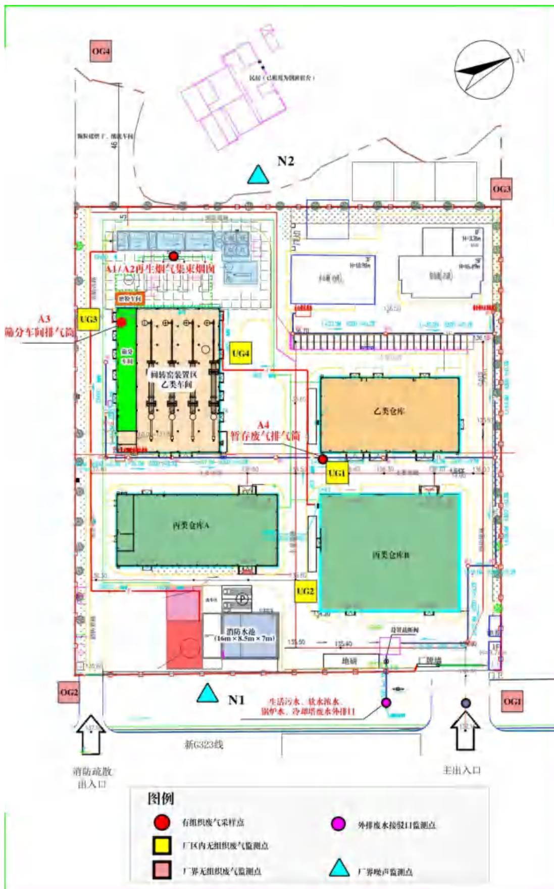
图 7.1-1 废水、有组织废气、无组织废气及噪声监测点位图
