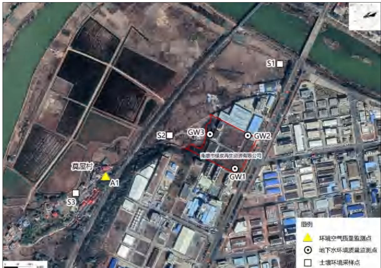
图 7-2-1 环境空气、土壤、地下水监测点位示意图
