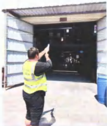
甲类车间二厂房外废气采样
