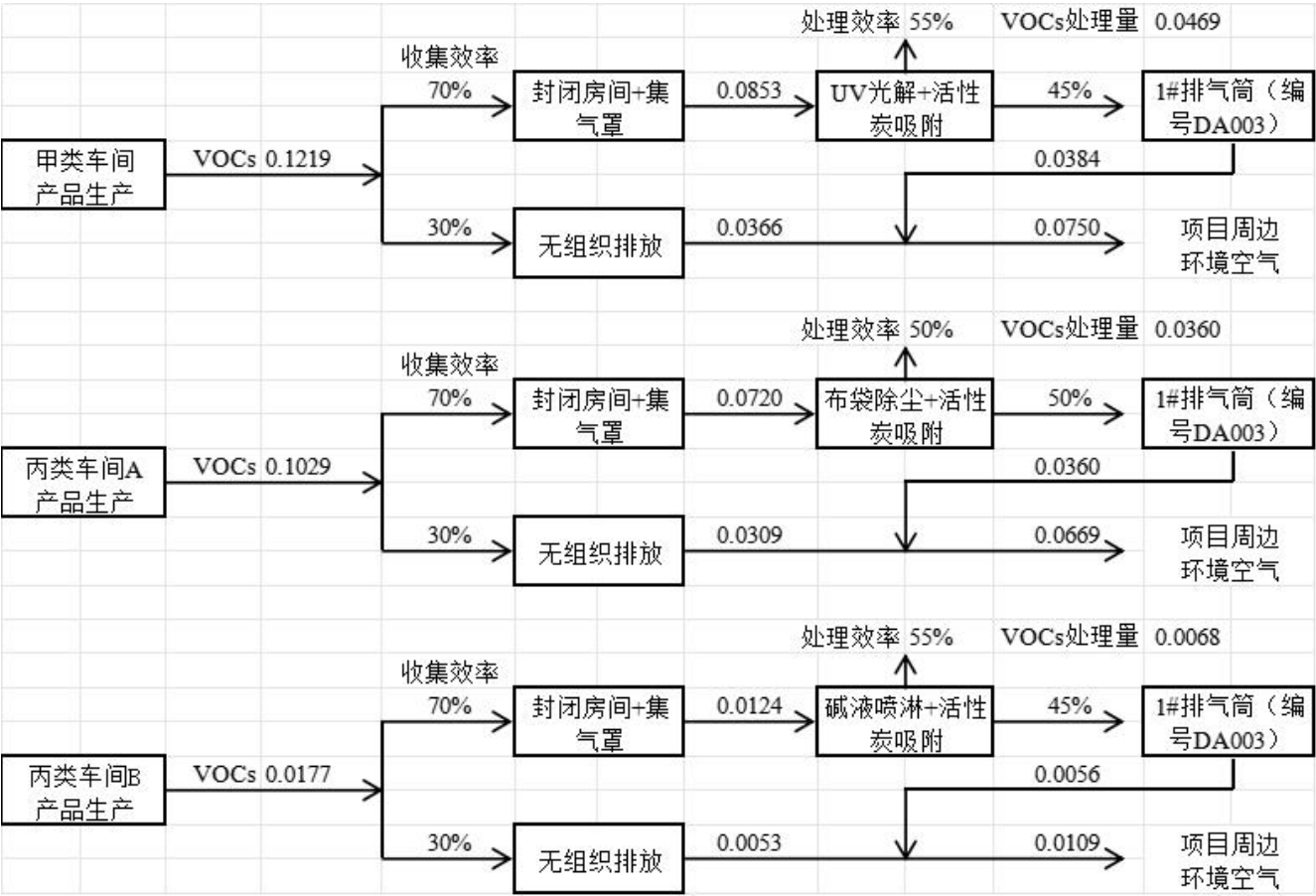
图 2-2 现有项目有害元素挥发性有机物 VOCs 的物料平衡图
