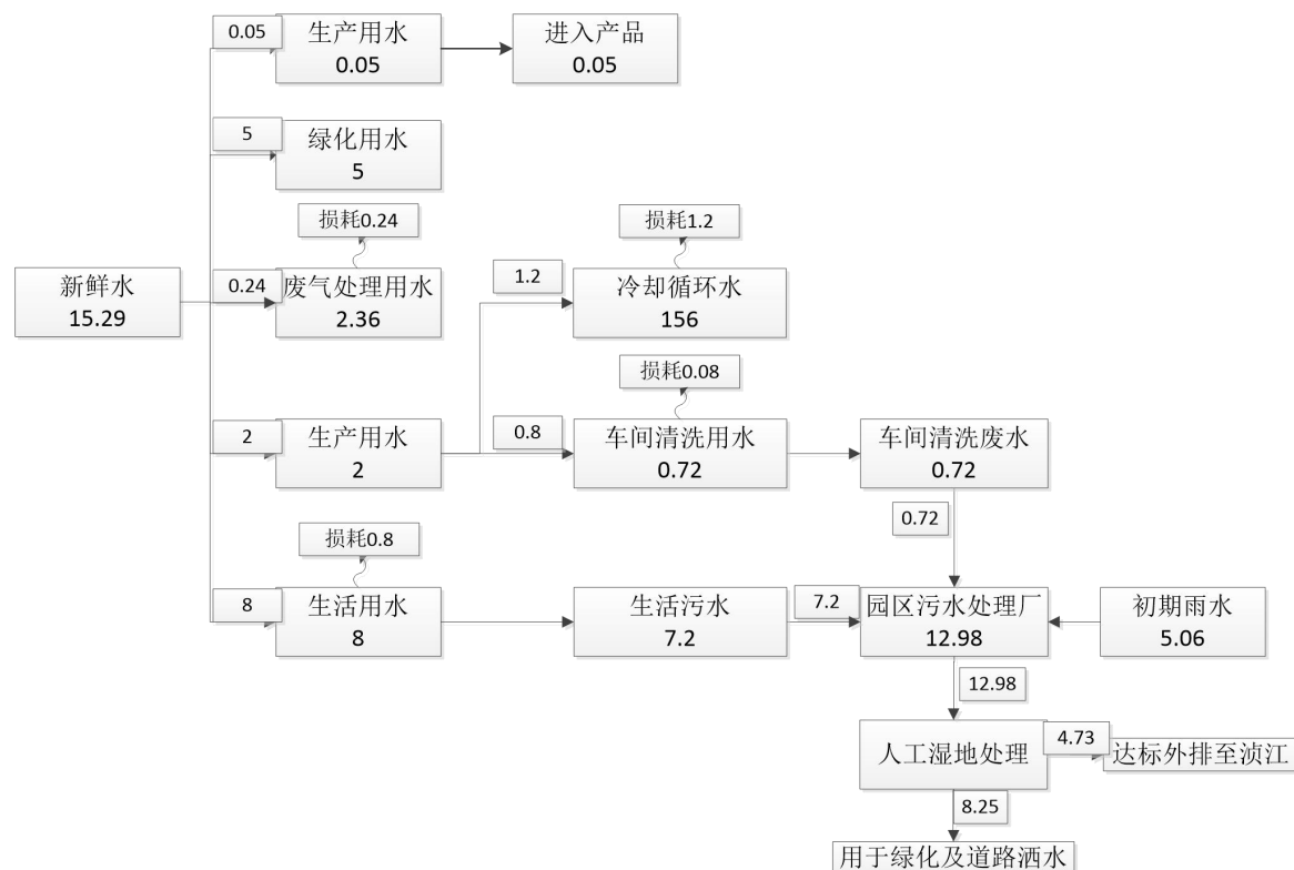
图3-6 本项目水平衡图（单位： \text{m}^3/\text{d} ）
