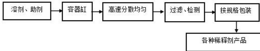
图 6 稀释剂类产品生产工艺流程
