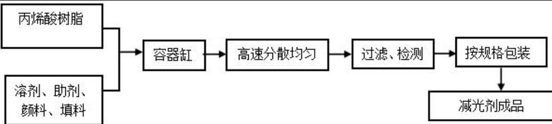
图9 减光剂生产工艺流程
