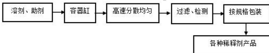
图 16 稀释剂类产品生产工艺流程
