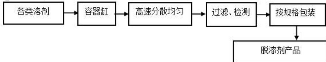
图 8 脱漆剂生产工艺流程
