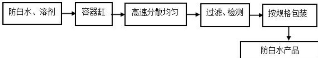
图 7 防白水生产工艺流程
