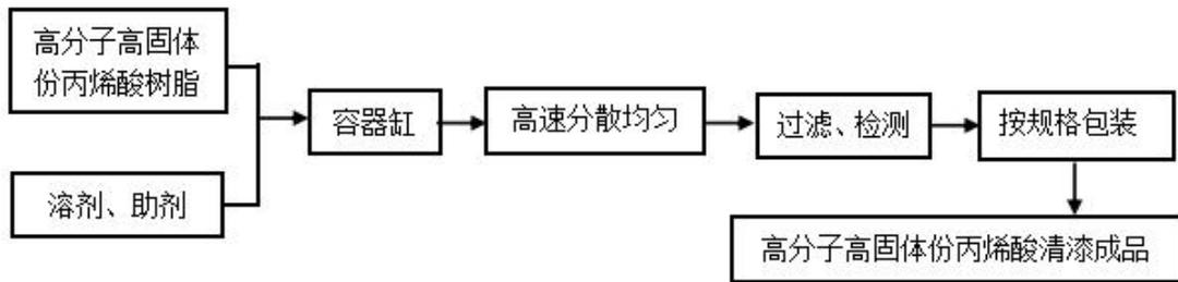
图1 高分子高固体份丙烯酸清漆生产工艺流程
