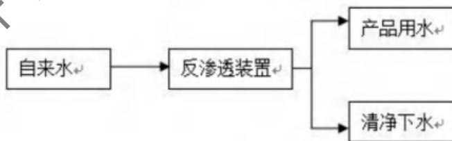
图2-14 去离子水制备工艺流程图
