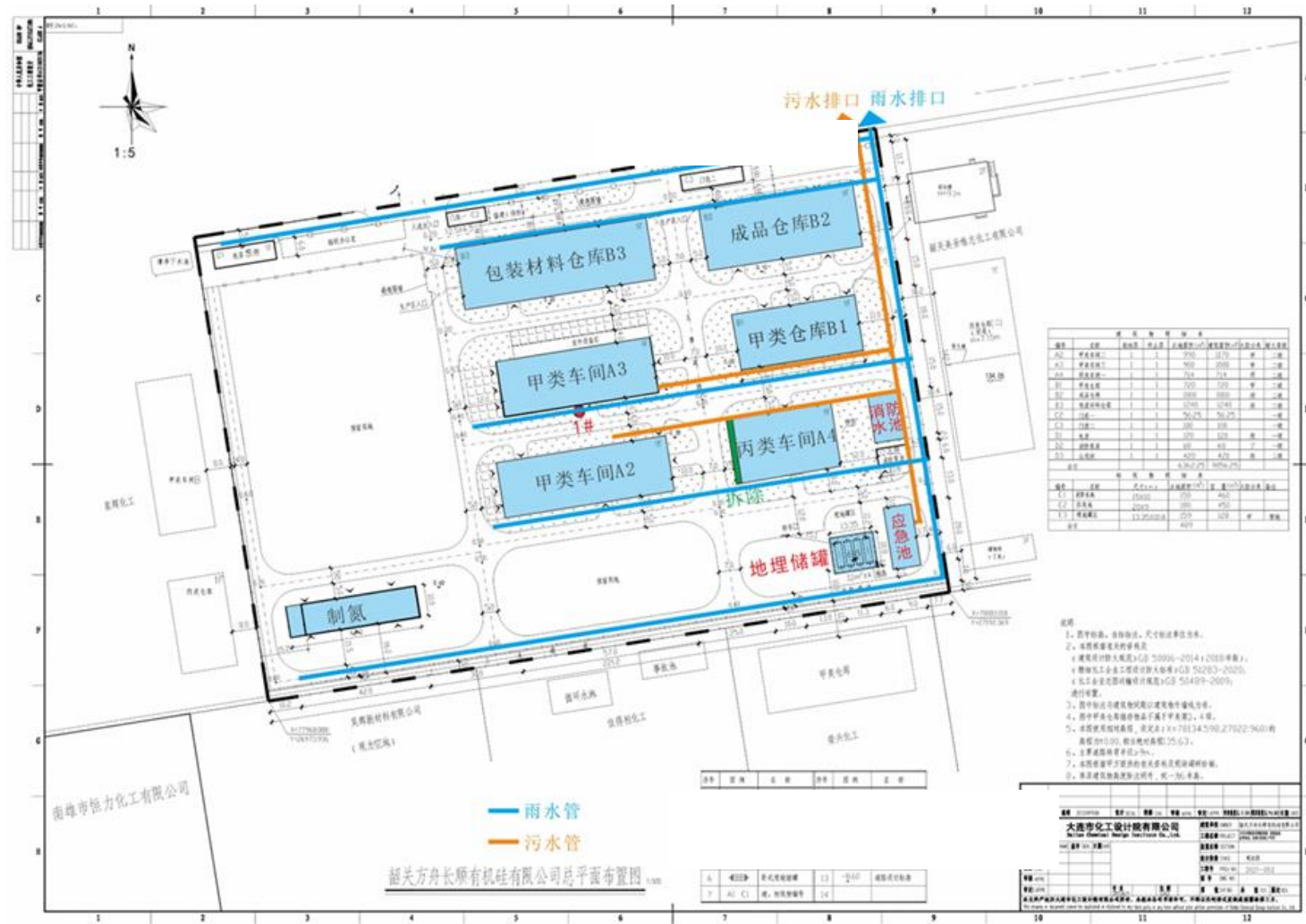
附图 6 厂区雨污管网图
