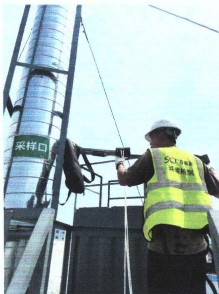
有组织废气 DA002 废气采样
