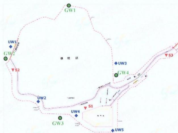
图1 地下水、无组织废气、土壤采样点位示意图
